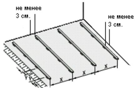
Рис. 5 Укладка с резиновыми прокладками по бетонному полу
