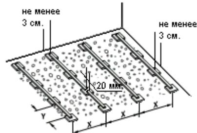
Рис. 4 Укладка на бетонных плитах
